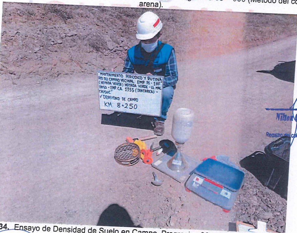
FIGURA N° 33. Ensayo de Densidad de Suelo en Campo. Progresiva 08 + 000 (Método del cono de arena).
