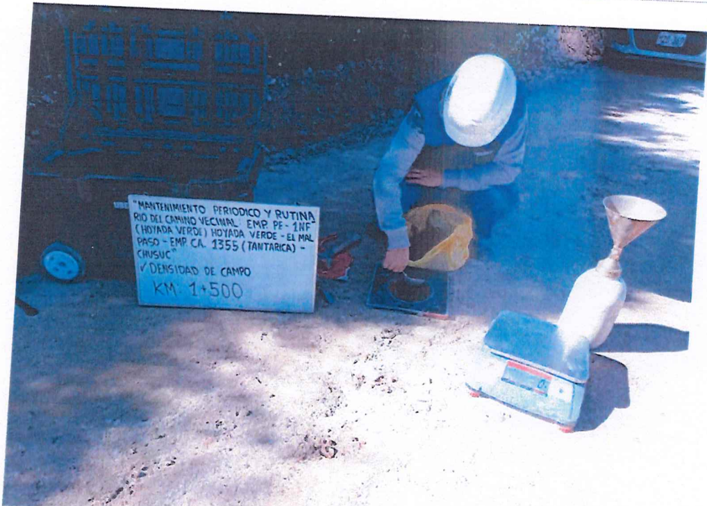
FIGURA N° 7. Ensayo de Densidad de Suelo en Campo. Progresiva 01 + 500 (Método del cono de arena).
